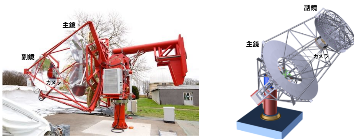
図 3.7 SC 光学系を採用する小口径望遠鏡 GCT の試作機（左）と SC 光学系を採用する中口径望遠鏡 SCT の完成予想図（右）。主鏡とは別に副鏡を備えており、主鏡と副鏡の間に焦点面カメラが設置される。（画像提供：CTA Consortium）
