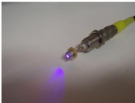
図 4.6 光源として使用する 405nm 波長の半導体レーザー
