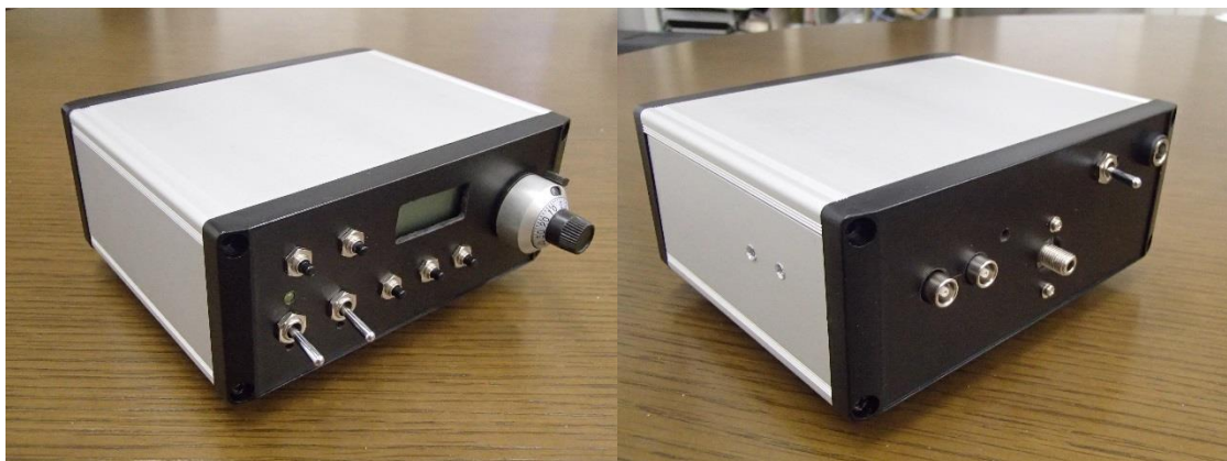
図 4.2 パルサー外観 Ver. 1 (上図) 及び Ver. 2 以降前面 (左下図)、Ver. 2 以降背面 (右下図)
