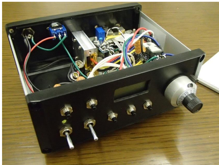
図 4.9 パッケージングしたピコ秒レーザーの内部
