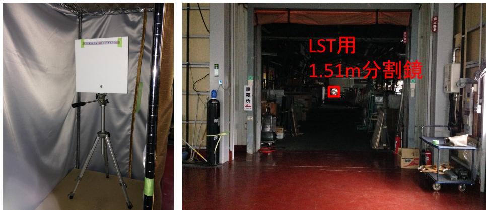
図 3.7: スクリーン (左) と 58 m 先に置かれた分割鏡の見え方 (右)
