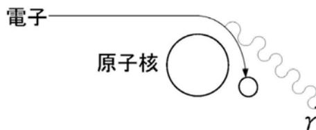
図 1.4: 制動放射模式図 [2]
