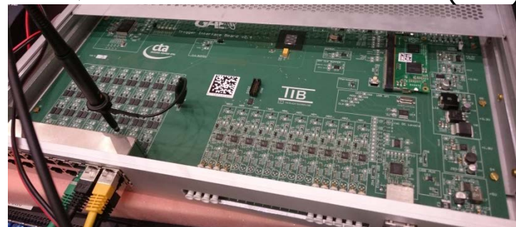
LST用トリガーインターフェースボード(TIB)
