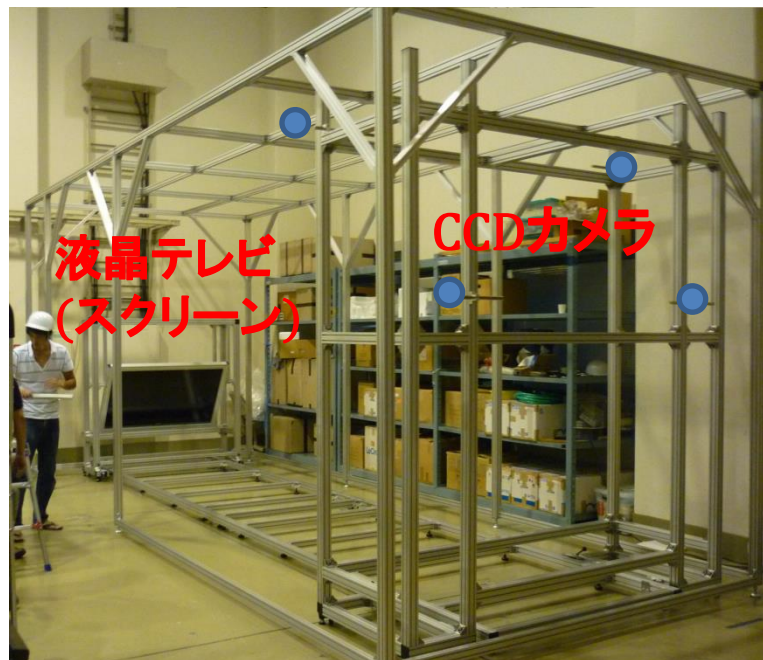
設置したPMD装置。CCDカメラ4台使用。 全長7m×3m×3m
