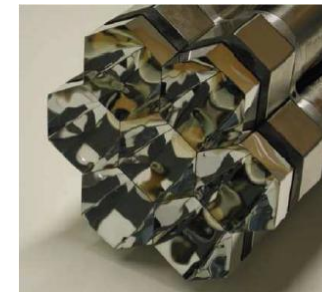
MAGICのライトガイド 反射材が貼ってあり、内側は鏡面になっている
