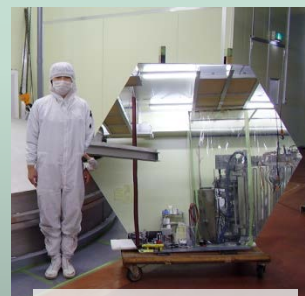
1.5m サイズ 高精度分割鏡
