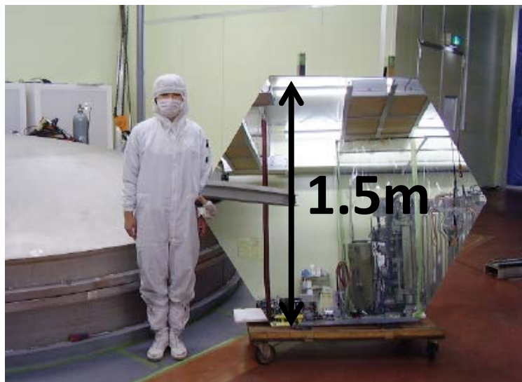
1.5mの六角形の試作鏡
